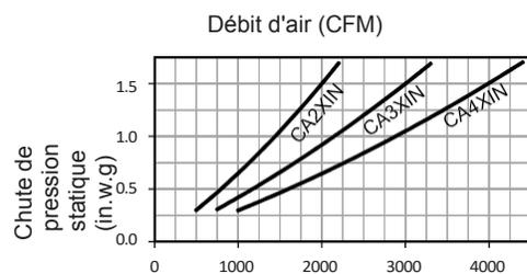
Remarque : les performances en matière de débit d'air tiennent compte de l'effet du filtre standard propre fourni avec l'appareil.
